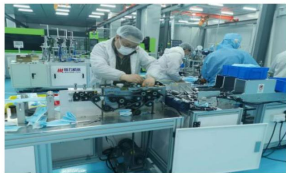
(项目现场-口罩机调试)
